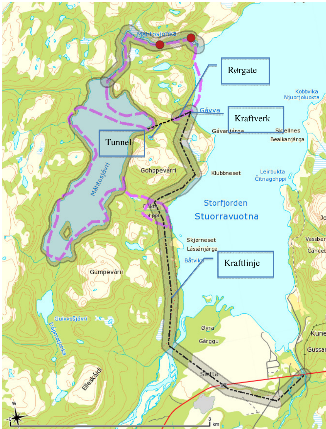
Figur 3. Kart over de viktigste installasjoner i forbindelse med tiltaket. Influensområdet (skravert) i henhold til tommelfingerregelen om at en sone på ca 100 meter langs berørte elvestrekninger og fysiske inngrep blir berørt. En har beregnet en buffersoner på 50 m langs breddene av magasinet. Befaringsrute er indikert med lilla stiplede strek. Røde prikker viser stasjoner for fiskeundersøkelser.
